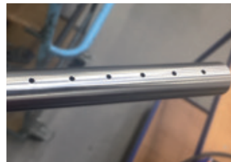
图8 拉丝模喷淋的新喷淋管路
