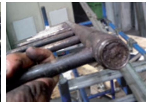
Bild 4. Mit Kupferschlamm verstopftes Besprührrohr der Ziehsteinbesprühung.
