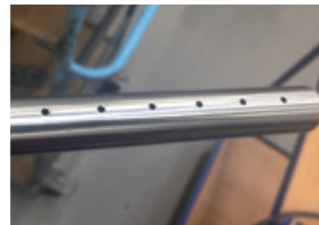
Bild 8. Neues Besprührohr der Ziehsteinbesprühung.
