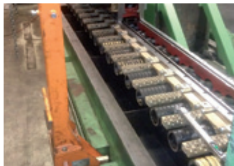
Bild 2. Ziehbereich der teilweise noch zerlegten, gereinigten und überholten MMH während des erneuten Zusammenbaus.
