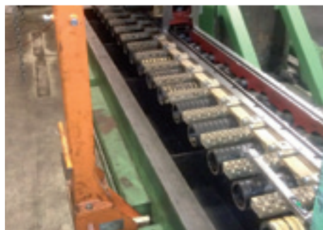
图2在大修过程中，MMH拉丝机的部件拆卸、清洁和修复。
