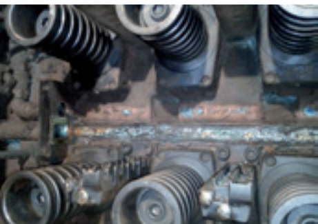
Bild 1. Ziehbereich einer MMH nach 65.000 Betriebsstunden.
