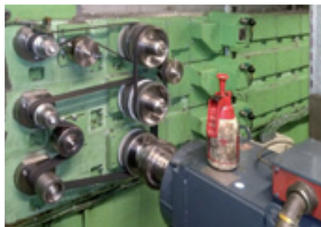
Bild 6. Riementrieb nach der Überholung.
