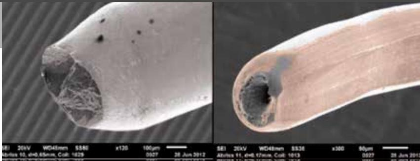
Bild 1. Die Drahtenden nach einem "Cup-and-Cone"-Bruch
