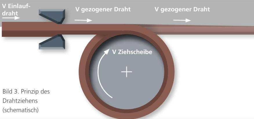
Bild 3. Prinzip des Drahtziehens (schematisch)
