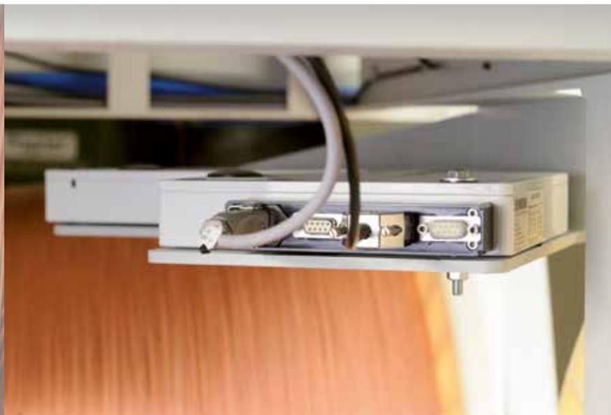
Bild 1. Durchmessererfassung des einlaufenden Kabels
