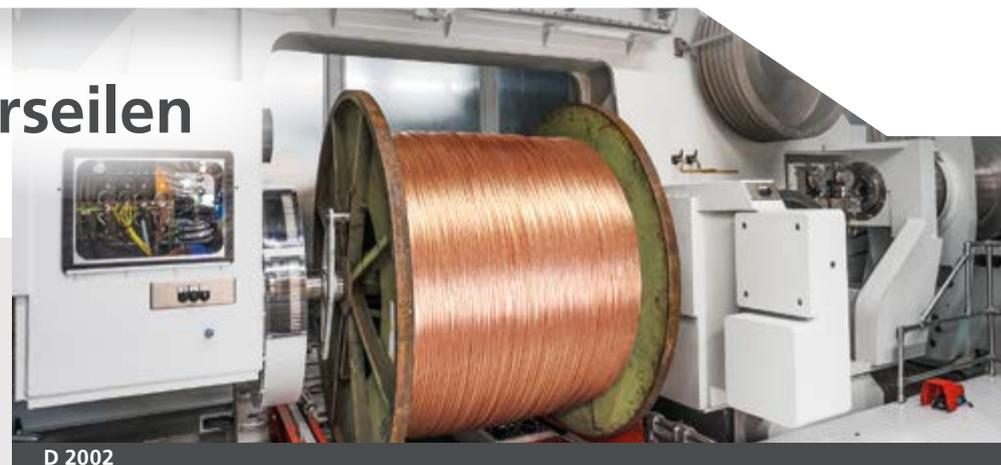
große Durchmesser haben und von der zweiten Umlenkrolle bis zur Abziehscheibe ein gerader Leiterverlauf gegeben ist, so dass der Leiter eine schonende Behandlung erfährt. Der Leiter kann über einen angetriebenen rotierenden Kompaktierstein mit Leiterschmierung verdichtet werden.
