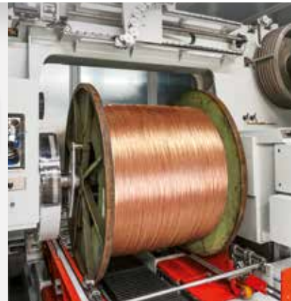
Bild 3. Die D 2002 nimmt Spulen mit 2 m Flanschdurchmesser auf
