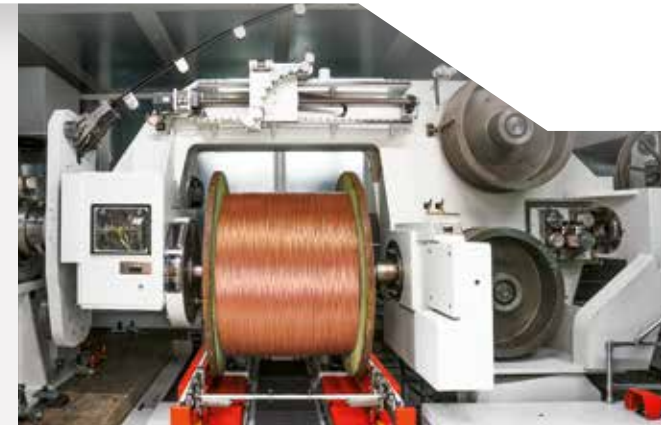
Bild 4. Eine weitere Besonderheit sind die energiesparende Einbügel-Bauweise und das NBAT-Verlegesystem
